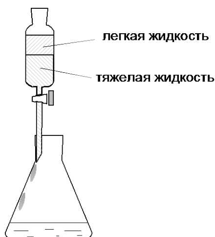
Рис.49. Разделение смеси с использованием делительной воронки
